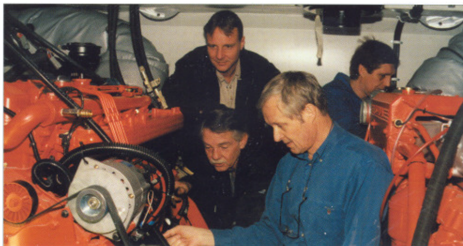
Trångt om utrymmet i maskinrummet på den nya lotsbåten. Här diskuterar friv Olle Wahlström, Olle Krogstad och Anders Boghammar en detalj på en av de två Scaniamotorena som ska svara för drivkraften i 12-metersbåten.
